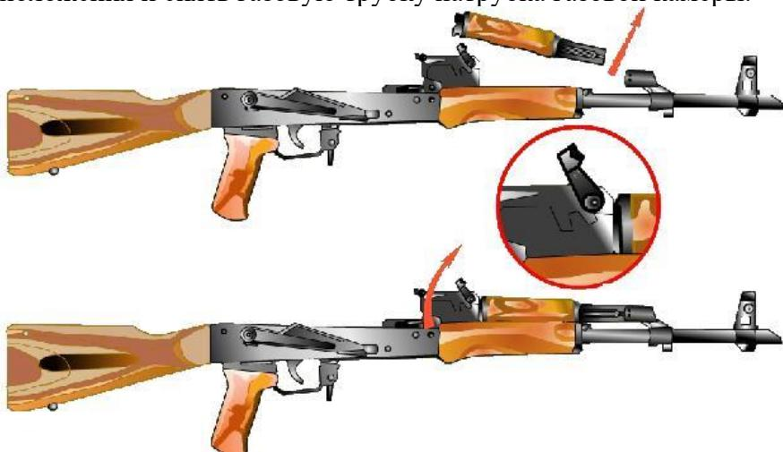
Рис. 9. Отделение газовой трубы со ствольной накладкой
